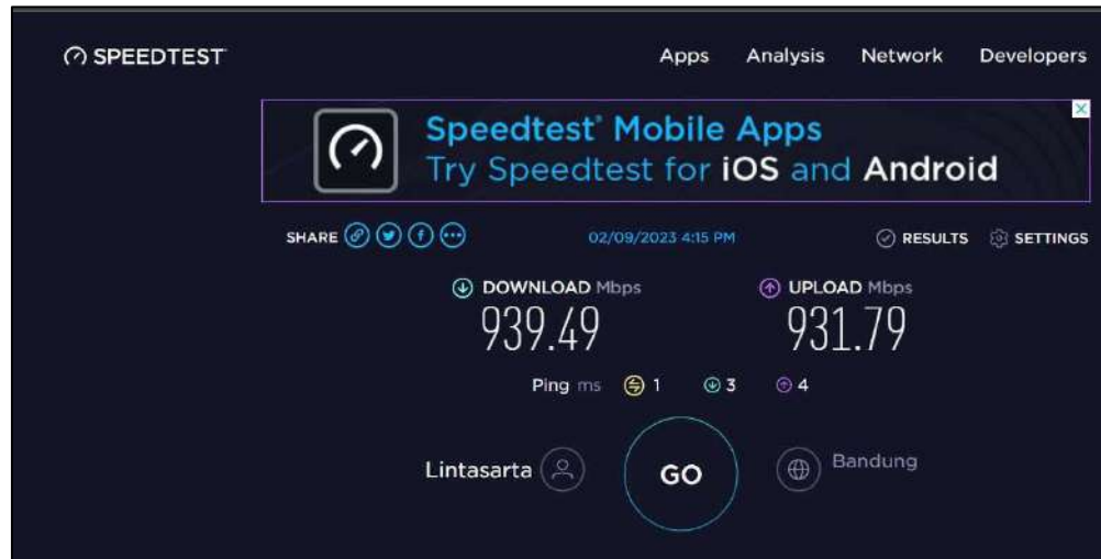
Gambar 3.22 Speed test yang di dapat dari Server yang menggunakan kabel LAN dan perangkat support 1Gbps
