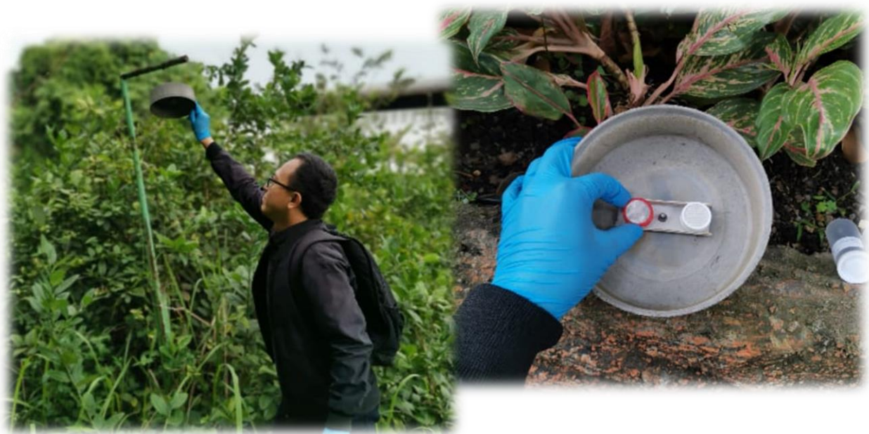
Gambar 3.4. Pemantauan Kualitas Udara Metode Passive Sampler
